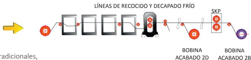
En el proceso de laminación en frío del acero inoxidable se pasa de la bobina negra al producto terminado con la reducción de espesor exacta en función de las características mecánicas a conseguir.
